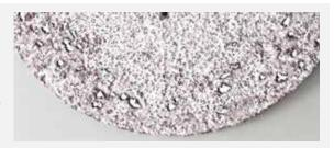
VSM STEARAT Plus: Es haften sichtbar deutlich weniger Späne an.
