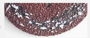
Mit Aluminiumspänen zugesetzte Fiberscheibe
