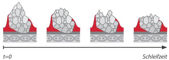
Aufgrund der mikrokristallinen Kornstruktur der **VSM CERAMICS** Serien baut sich das Keramik Korn beim Schleifprozess definiert ab und erzeugt dadurch immer wieder neue, scharfe Schneidkanten.
